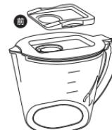
切り替えカバーは前後が逆になると、本体に設置できないため、必ず図のように山のように出っ張っている部分が取手側になるように設置して下さい。
